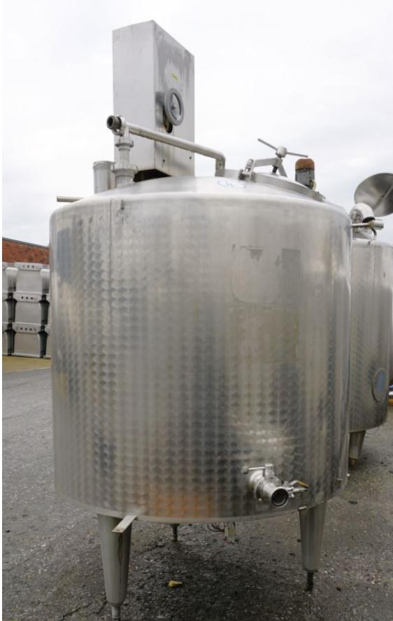
Behälter 1.000 Liter aus V2A isoliert, gebraucht besteht aus dem Material 1.4301(AISI304) V2A. Das Volumen beträgt ca. 1.000 Liter. Der Durchmesser innen umfasst 1200 mm.
