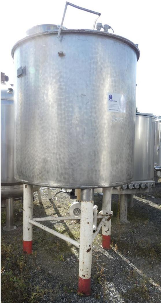
Behälter 1.400 Liter aus V4A einwandig, gebraucht besteht aus dem Material 1.4571(AISI316) V4A. Das Volumen beträgt ca. 1.400 Liter.
