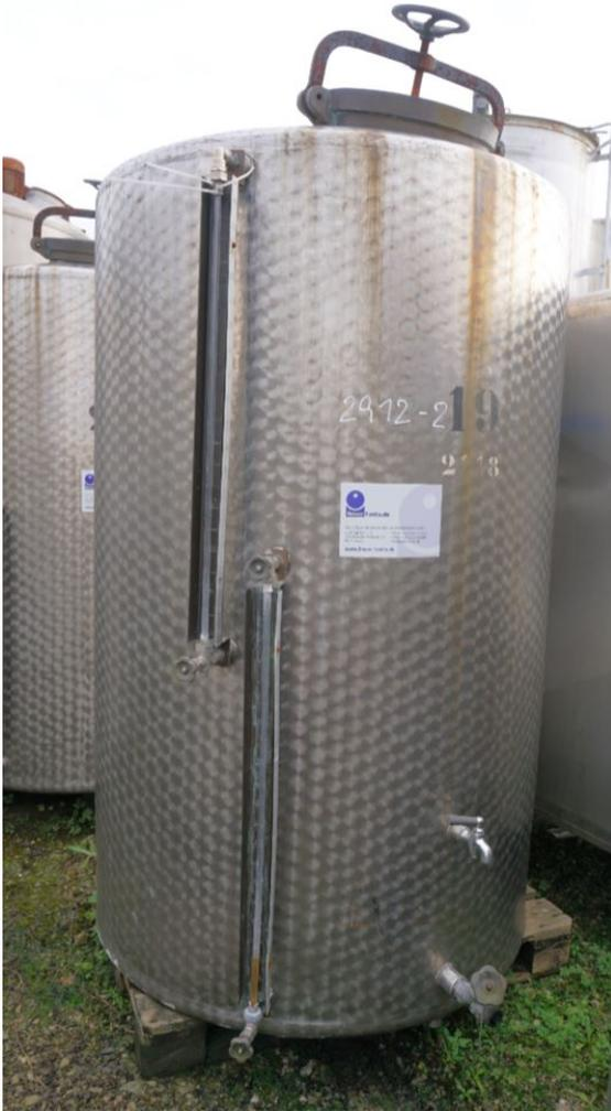
Behälter 1.900 Liter aus V2A, einwandig, gebraucht besteht aus dem Material 1.4301(AISI304) V2A. Das Volumen beträgt ca. 1.900 Liter.
