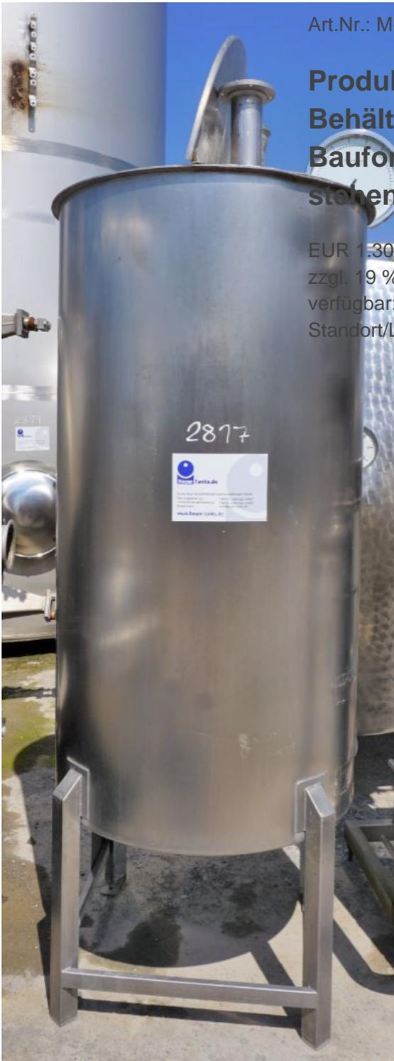
Behälter 750 Liter aus V2A einwandig, gebraucht Bauform: stehend besteht aus dem Material 1.4301(AISI304) V2A. Das Volumen beträgt ca. 750 Liter.
