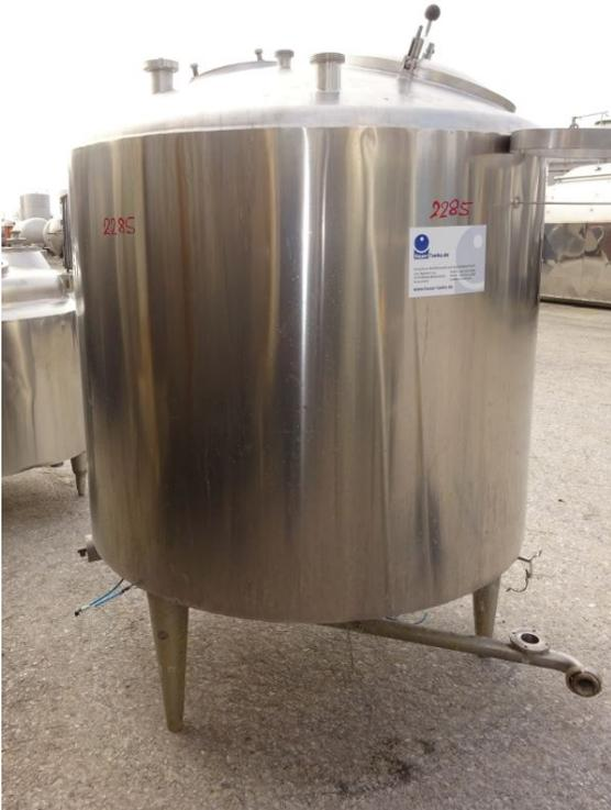
Behälter 1.000 Liter aus V4A isoliert, gebraucht besteht aus dem Material 1.4539. Das Volumen beträgt ca. 1.000 Liter. Der Durchmesser innen umfasst 1020 mm.
