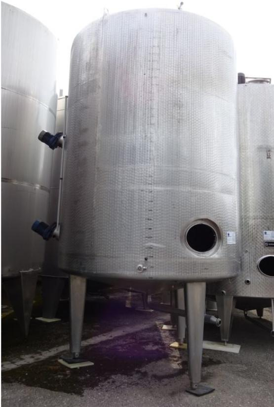
Behälter 16.000 Liter aus V2A, gebraucht, isoliert besteht aus dem Material 1.4301(AISI304) V2A. Das Volumen beträgt ca. 16.000 Liter. Der Durchmesser innen umfasst 2500 mm.
