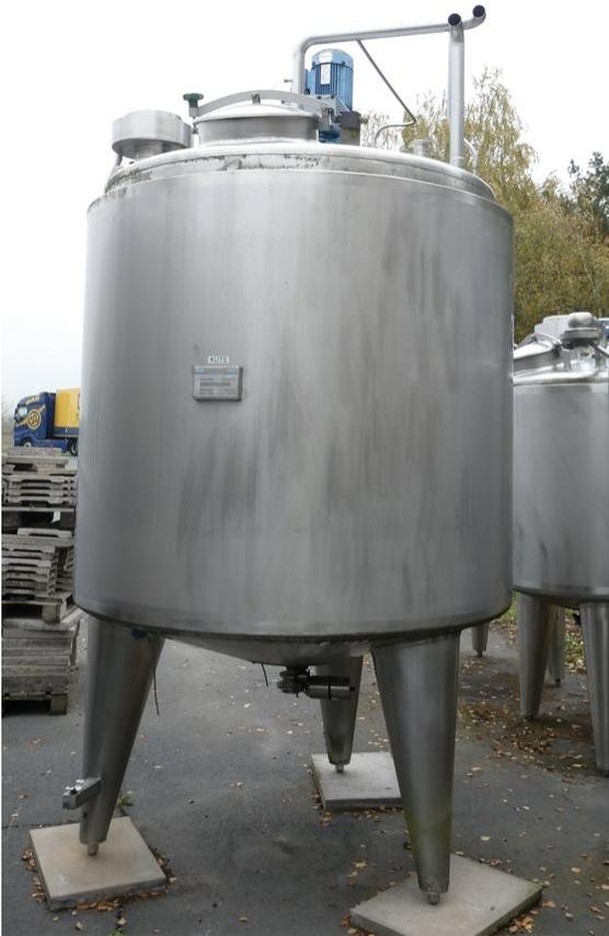
Behälter 3.000 Liter aus V2A isoliert, temperierbar, gebraucht besteht aus dem Material 1.4301(AISI304) V2A. Das Volumen beträgt ca. 3.000 Liter. Der Durchmesser innen umfasst 1600 mm.
