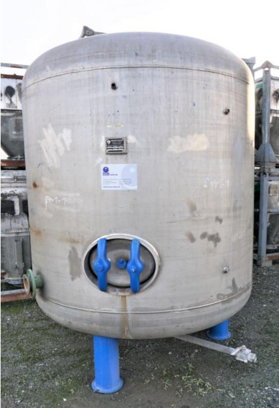
Behälter 5.000 Liter aus V4A einwandig besteht aus dem Material 1.4571(AISI316) V4A. Das Volumen beträgt ca. 5.000 Liter.
