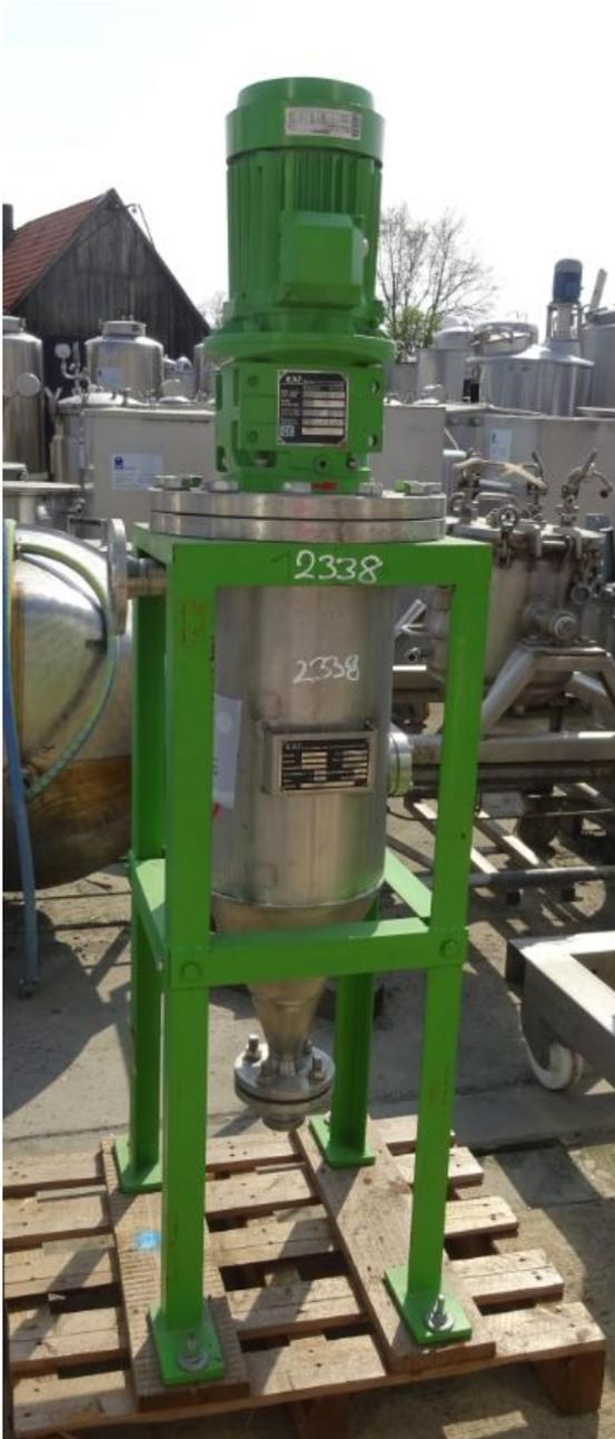
Rühranlage 25 Liter aus V4A einwandig besteht aus dem Material 1.4571(AISI316) V4A. Das Volumen beträgt ca. 25 Liter.
