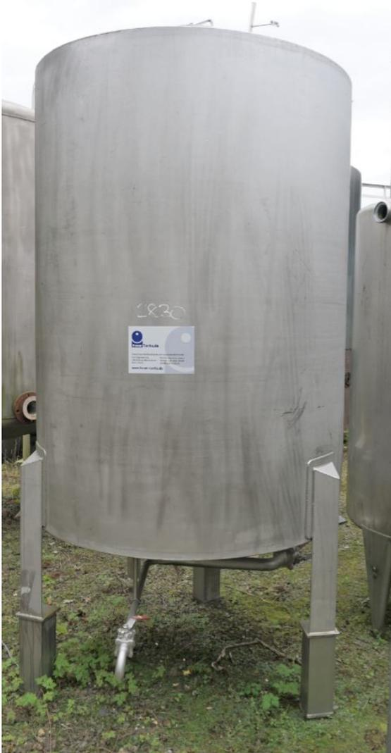
Behälter 1.800 Liter aus V2A einwandig, gebraucht besteht aus dem Material 1.4301(AISI304) V2A. Das Volumen beträgt ca. 1.800 Liter.
