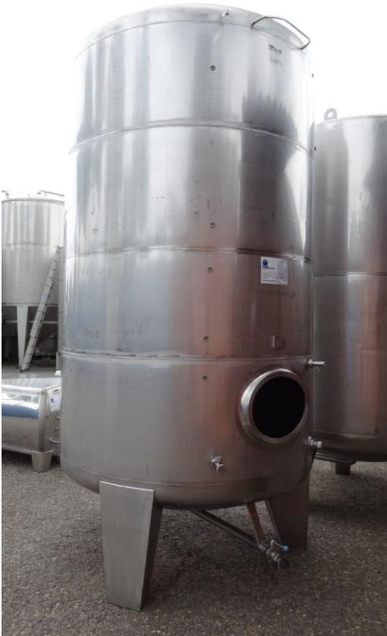
Behälter 6.600 Liter aus V2A, gebraucht, einwandig besteht aus dem Material 1.4301(AISI304) V2A. Das Volumen beträgt ca. 6.600 Liter.
