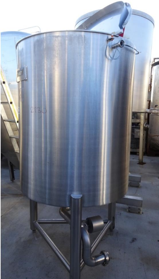
Behälter 1.000 Liter aus V2A, gebraucht, einwandig besteht aus dem Material 1.4301(AISI304) V2A. Das Volumen beträgt ca. 1.000 Liter.
