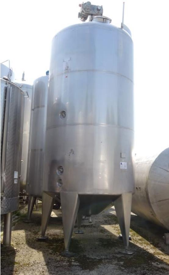
Behälter 15.000 Liter aus V2A, gebraucht, isoliert besteht aus dem Material 1.4301(AISI304) V2A. Das Volumen beträgt ca. 15.000 Liter. Der Durchmesser innen umfasst 2200 mm.
