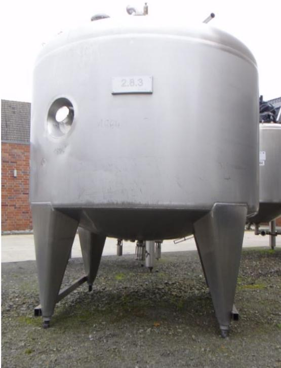
Behälter 3.000 Liter aus V2A, gebraucht, temperierbar, isoliert besteht aus dem Material 1.4301(AISI304) V2A. Das Volumen beträgt ca. 3.000 Liter. Der Durchmesser innen umfasst 1850 mm.
